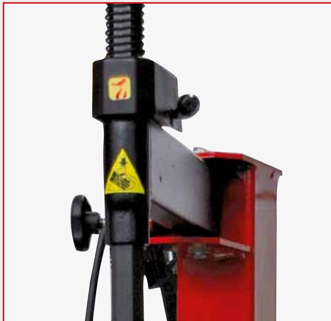
Die **Stellung des Werkzeugs** erfolgt durch einen Hebel. Die gewählte Position bleibt für den Reifen gleicher Größe eingestellt. Beim **Einstellen des vertikalen Arms** weicht das Werkzeug vom Felgenbord automatisch ab, um Beschädigungen zu vermeiden.
